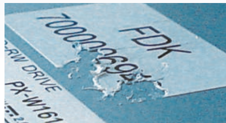
Dokumentenfolie – selbstzerstörend bei Ablöseversuch
