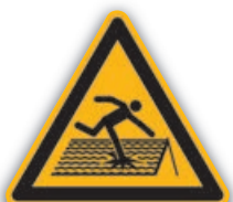
Warnung! nicht durchtrittsicherem Dach DIN EN ISO 7010 W036
